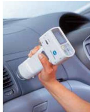
O cabeçote de medição pode ser utilizado independentemente do processador de dados. Isto é vantajoso quando a portabilidade é necessária ou o espaço disponível é limitado.
